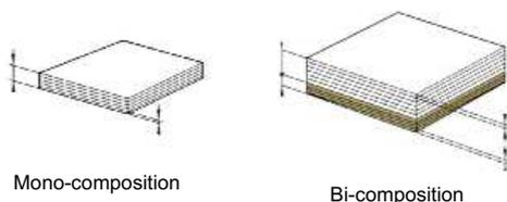
(Exemple de bi-composition : une cale d'1 mm d'épaisseur totale composée de 8 feuilles de 0,1 mm et de 4 feuilles de 0,05 mm)
